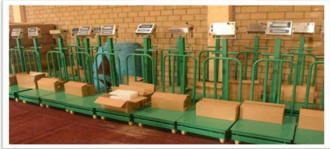
Picha Na.11: Mizani ya Kidigiti inayotumiwa na Vyama vya Ushirika kupima mazao
